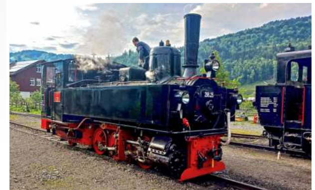
Mai 2024 – Erstinbetriebnahme, Einstellung von Steuerung und Sicherheitsventilen.
