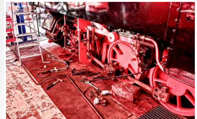
Dezember 2023 – Reparatur Treibstangen, Lager, Steuerung
