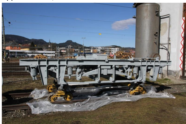
Laufdrehgestell ohne Achsen, grundiert
