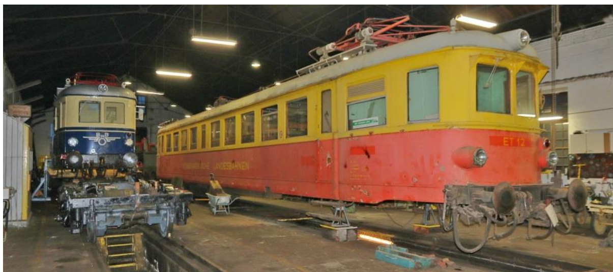
Im Zuge des Tausches der Drehgestelle mussten beide Triebwagen aufgehoben werden.
