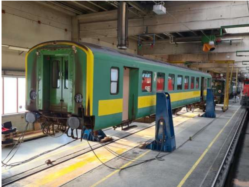
Die Drehgestelle wurden bei allen Wagen für deren Revision entfernt, 6. März 2021. (Foto: Markus Rabanser)
