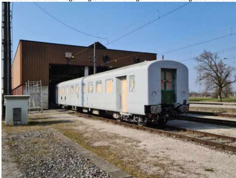
Am 19. März 2022 zeigte sich der nächste Wagen nach dem Sandstrahlen in der Grundierlackierung. Schadhafte Teile des Wagenkastens wurden ersetzt oder verkittet. (Foto: Markus Rabanser)
