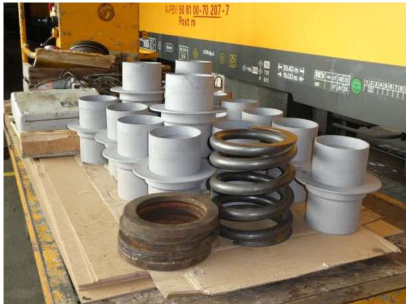
Die Aufarbeitung vieler Kleinteile, wie hier die Drehgestellöpfe und -federn benötigt viel Zeit und Mühe (Foto: Stefan Zorell)
