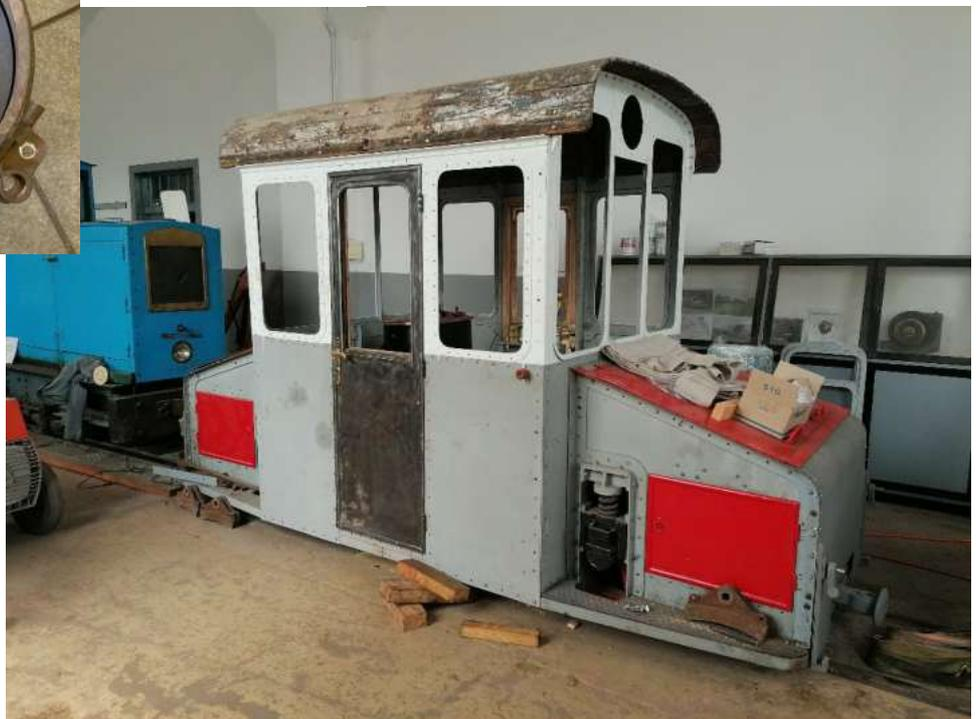
Der aufgearbeitete Stromabnehmer und seine Holzauflage lagen schon für die anschließende Montage bereit wie auch alle anderen noch fehlenden Kleinteile, ebenso wurden währenddessen - in den Pausen zwischen den Lackiervorgängen - schon die in ihren Rahmen vorbereiteten Fenster montiert.
