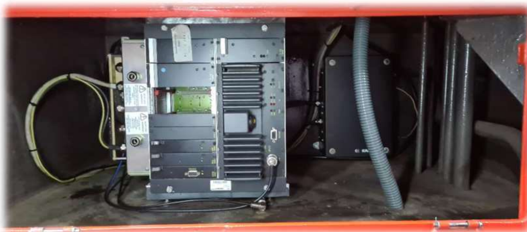
Bild 9: Inbetriebnahme der Zugfunk-Anlage, Mai 2022. (Foto: Ing. Stefan Rottensteiner)
