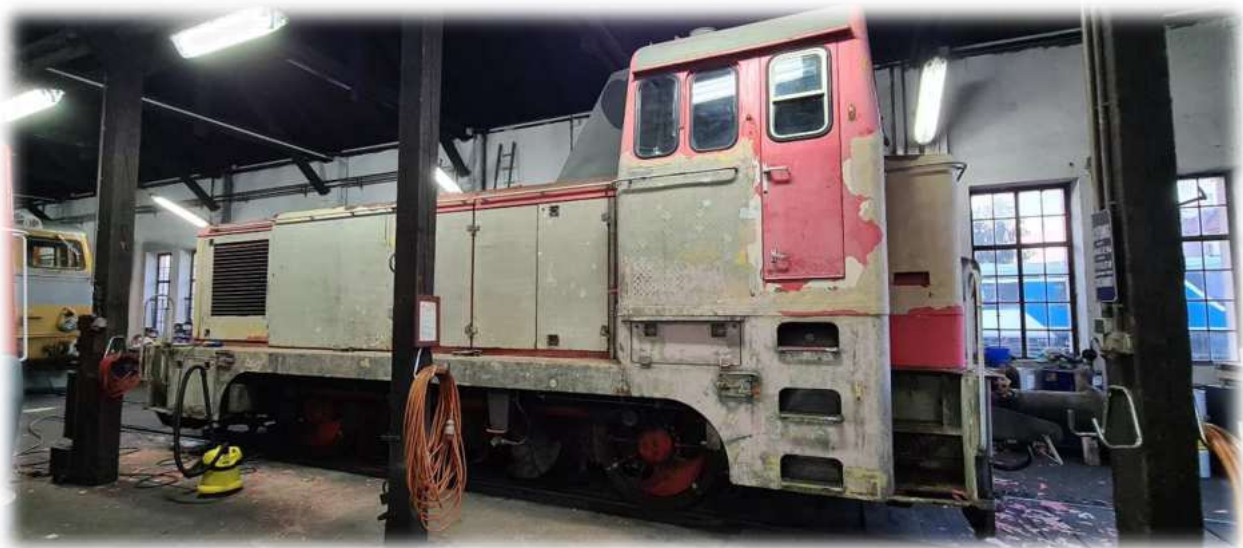
Bild 10: Entfernen sämtlicher Lackschichten, Sommer 2021 (Foto: Ing. Stefan Rottensteiner)
