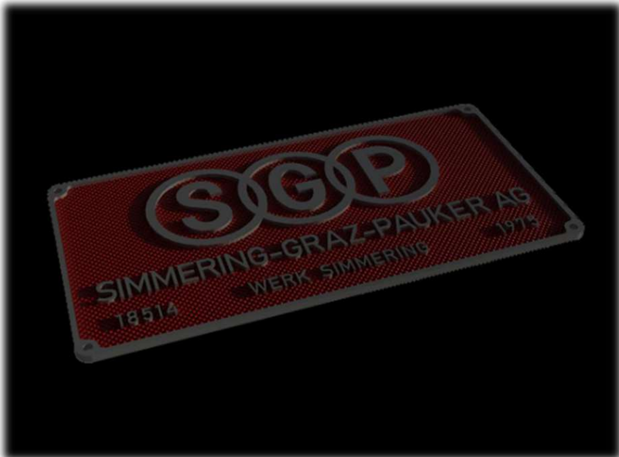
Bild 12: CAD-Entwurf des Fabrikschildes für den 3D-Druck. (Foto: Ing. Stefan Rottensteiner)
